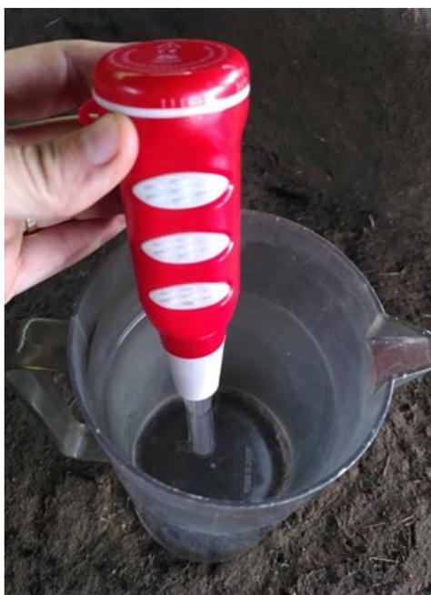
**Abbildung 4** Wasserdeseinfektion via UV-Strahlung (Quelle: Eigenes Foto)
